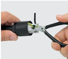
Adern in die gekennzeichneten (1, 2, 3 ...) Aderführungen einrasten. Litzenenden bündig abschneiden.
