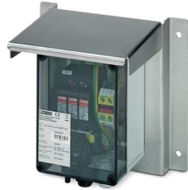
Wetterschutzdach zum Schutz des Generatoranschlusskastens (GAK) vor Umwelteinflüssen bei Montage im Aussenbereich, aus Edelstahl, mit rückseitigem M8-Erdungsbolzen, inkl. Befestigungsmaterial für GAK und Erdungsleitung.
