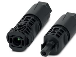
Steckverbinder, Artikelfamilie: SUNCLIX, Material Gehäuse: PPE, Farbe: schwarz, Polzahl: 1, Aderquerschnitt min.: 6 mm<sup>2</sup>, Aderquerschnitt max.: 16 mm<sup>2</sup>, Bemessungsspannung: 1500 V DC, Bemessungsstrom: 60 A, Anschlussart: Federkraft.
