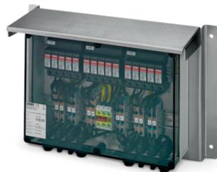
Wetterschutzdach zum Schutz des Generatoranschlusskastens (GAK) vor Umwelteinflüssen bei Montage im Aussenbereich, aus Edelstahl, mit rückseitigem M8-Erdungsbolzen, inkl. Befestigungsmaterial für GAK und Erdungsleitung.
