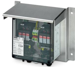
Wetterschutzdach zum Schutz des Generatoranschlusskastens (GAK) vor Umwelteinflüssen bei Montage im Aussenbereich, aus Edelstahl, mit rückseitigem M8-Erdungsbolzen, inkl. Befestigungsmaterial für GAK und Erdungsleitung.
