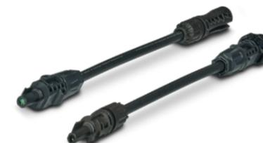
Artikelfamilie: SUNCLIX, Bauform: Adapter, Material Gehäuse: PPE, Farbe: schwarz, Bemessungsstrom: 35 A, Kabellänge: 150, Verbinden sie die Steckverbinder untereinander nur mit Steckverbindern des gleichen Herstellers und des gleichen Typs. Beachten Sie bei dem Verbinden unbedingt die Angaben zu Nennspannung und Nennstrom. Der kleinste gemeinsame Wert ist zulässig. PV-AS-MC4/6-150-MN-SET1
