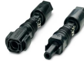
Photovoltaik-Steckverbinder, Artikelfamilie: SUNCLIX, Material Gehäuse: PPE, Farbe: schwarz, Polzahl: 1, Aderquerschnitt min.: 2,5 mm<sup>2</sup>, Aderquerschnitt max.: 6 mm<sup>2</sup>, Bemessungsspannung: 1100 V DC, Bemessungsstrom: 35 A, Anschlussart: Federkraft.
