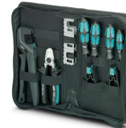
Werkzeug-Etui, bestückt mit: Presszange, Gesenke für MC3, MC4 und SOLARLOK Verbinders, Abisolierwerkzeug für marktübliche Solarleitungen, Abisolierwerkzeug für SUNCLIX, VDE Kabelschneider, VDE Schraubendreher: PH1, PH2, Schlitz 0,6x3,5 und 0,8x4,0.
