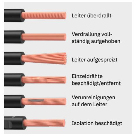
Abisolierfehler nach DIN IEC 60352-2
