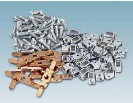
金属件 金属件的表面不含铅，采用锌镍或锡的涂层防护性材料。导流条为高级铜合金，具有良好的导电性能，发热少。通过优质钢制夹线体来保证压紧力。
