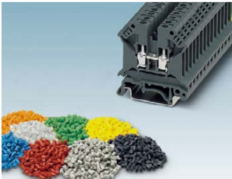
塑料件 TB 组合式接线端子均由可循环利用的高级无卤素尼龙（PA6.6）制成。该材料满足UL94 的最高标准，阻燃等级V0，并适用于-60 至+130° C 的温度范围。
