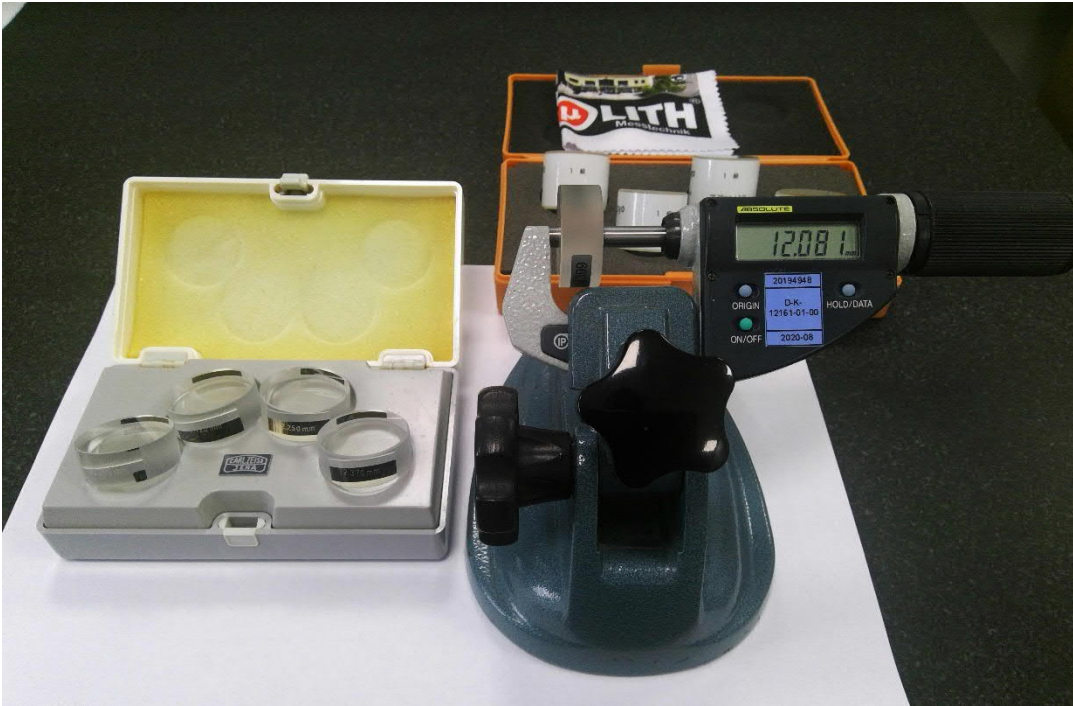
Abbildung 1: Parallelitätsprüfung der Messflächen
