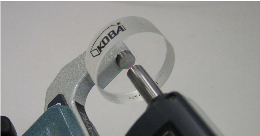
Abbildung 2: Parallelitätsprüfung der Messflächen
