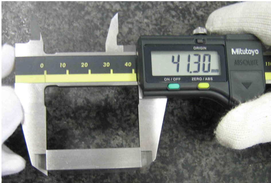
Abbildung 3: Endmaß zwischen den abgesetzten Messflächen
