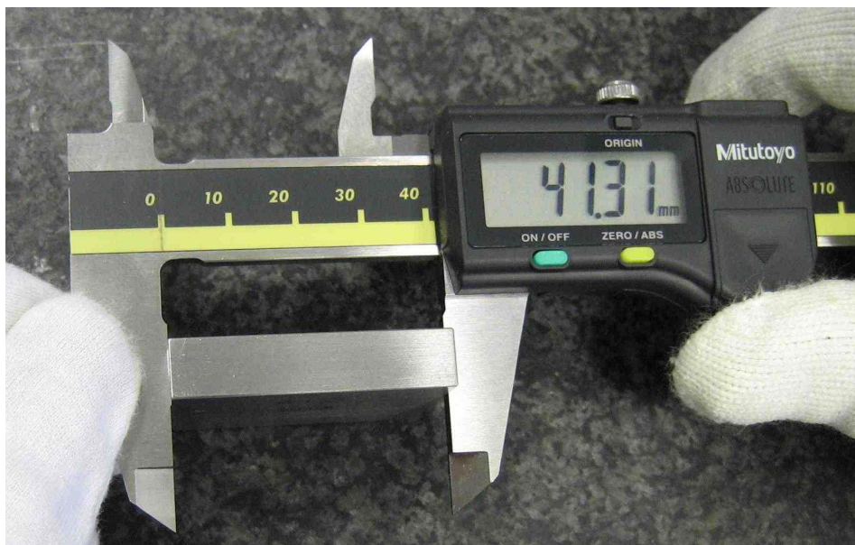
Abbildung 2: Endmaß in der Mitte der Messschnäbel
