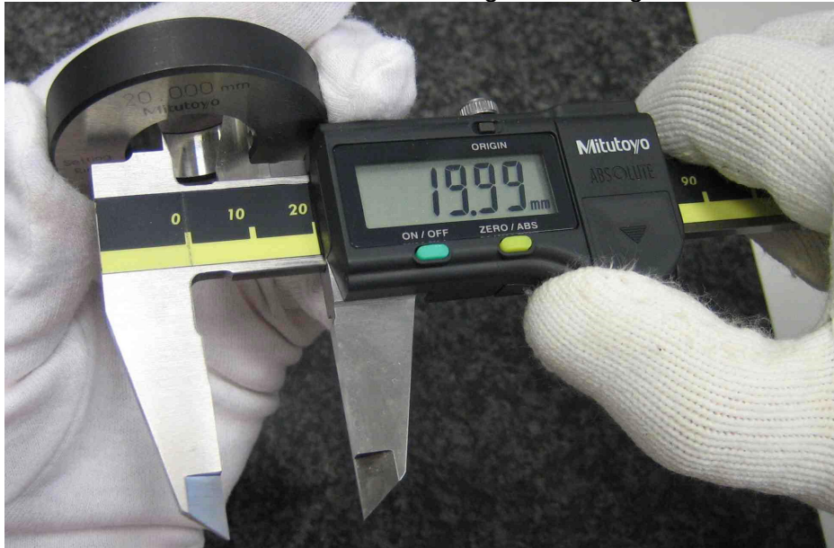
Abbildung 4: Einstellring in der Mitte der Kreuzschnäbel
