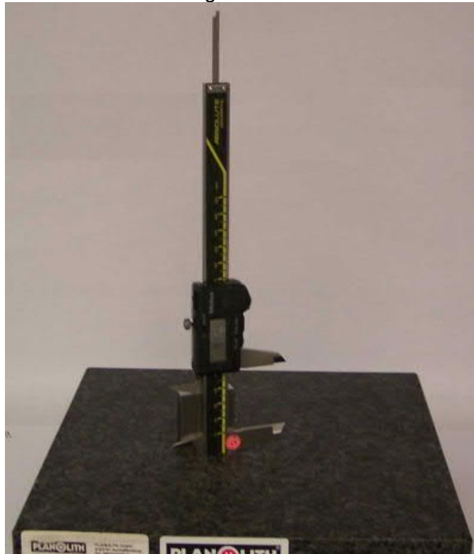
Abbildung 6: Stufenmessung mit Parallelendmaß
