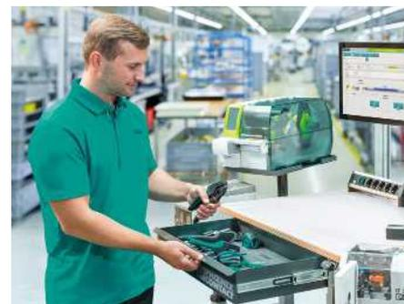
Tiempos de búsqueda y acceso cortos mediante la disposición y el posicionamiento estructurados de las herramientas y los medios auxiliares utilizando el principio 5S.
