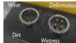
繰り返し挿抜によるピン曲がり・接触不良など、接続部トラブルを非接触接続により軽減
