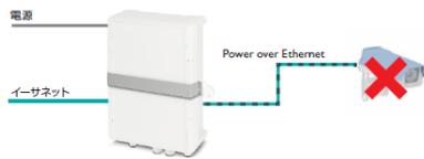
遠隔のPoE機器がPingに反応しない場合、自動的に再起動可能 (ウォッチドッグ機能)
