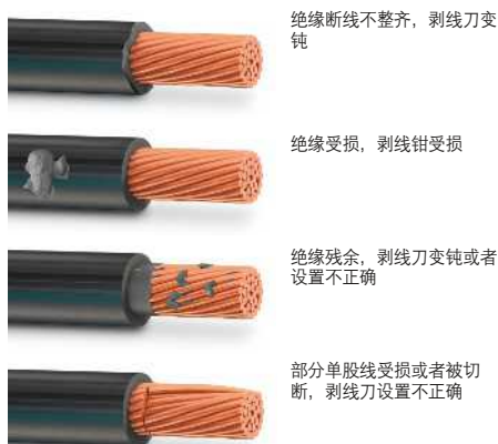
根据DIN IEC 60352-2标准错误剥线的电缆
