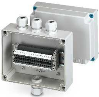
接线箱，带有20个2.5 mm²接线端子，采用螺纹接头技术
