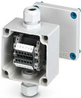
接线箱，带有6个2.5 mm²接线端子，采用螺纹接头技术
