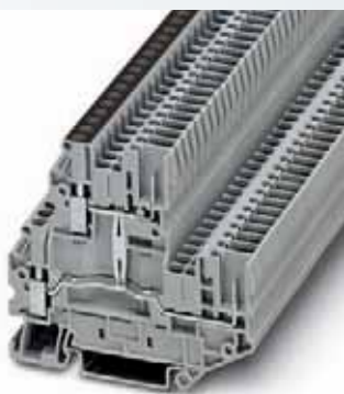
2.5 (4) mm², 24 A, 双层接线端子, 内连接层
