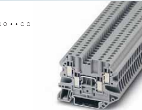
2.5 (4) mm², 30 A, 直通式接线端子, 两进两出
