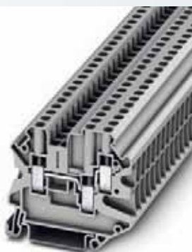
4 (6) mm 2 , 41 A, 1000 V, 直通式接线端子, 一进两出
