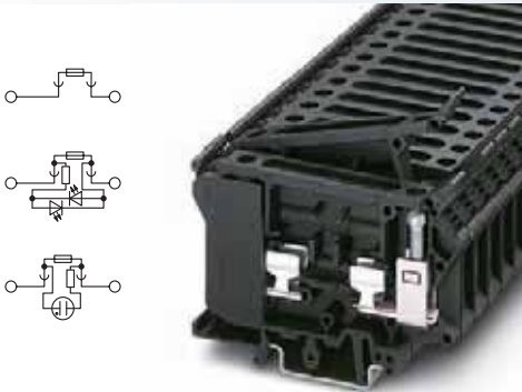
16 (16) mm², 10 A, 悬臂式保险丝端子, 可接 6.3 x 32 mm 桥接保险丝
