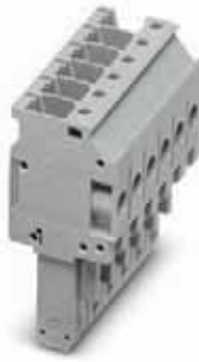
4 (6) mm 2 , 32 A, 插头, 导线连接方向与插拔方向平行, 不可桥接
