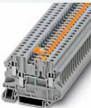
4 (6) mm², 20 A, 刀闸分断端子, 一进两出
