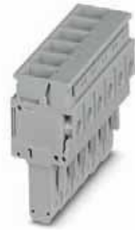
6 (10) mm 2 , 41 A, 插头, 导线连接方向与插拔方向平行
