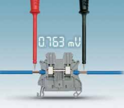
螺钉端子的压降测试
