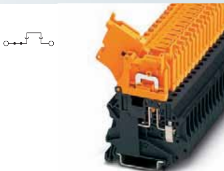
4 (6) mm 2 , 20 A, 悬臂式刀闸端子, 外形与保险 丝端子相同
