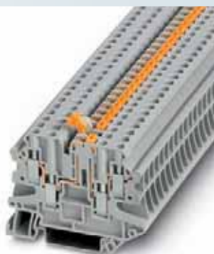
4 (6) mm², 20 A, 刀闸分断端子, 两进两出
