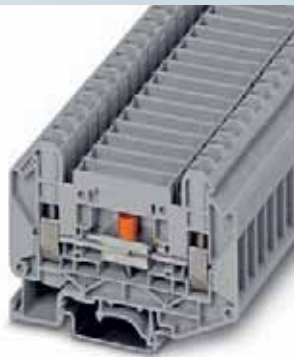
6 (10) mm², 57 A, 1000 V, 分断测试端子
