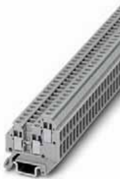
1.5 (1.5) mm 2 , 17.5 A, 直通式接线端子, 一进两出
