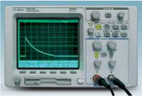
示波器显示了脉冲耐受电压的时间波形
