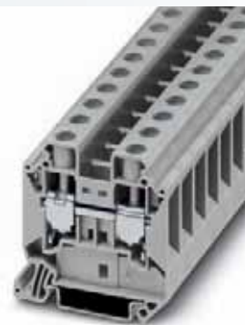
16 (25) mm 2 , 101 A, 直通式接线端子
