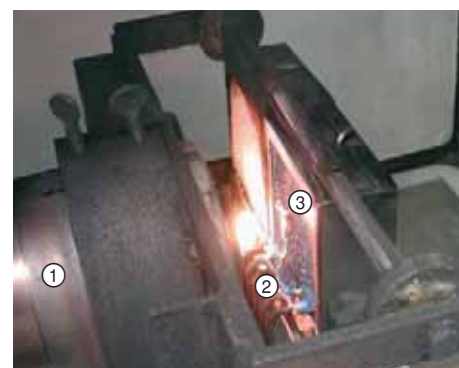
① 照射热源 ② 火焰 ③ 塑料试件
