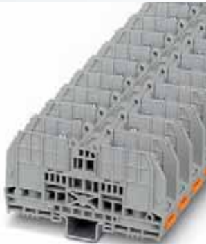
70 (70) mm 2 , 192 A, 直通式接线端子，安装在 DIN 导轨上或直接安装
