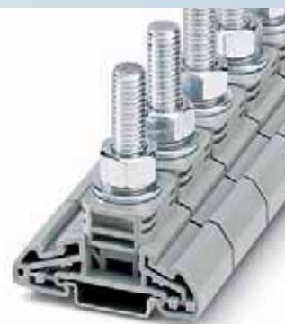
120 (120) mm², 269 A, M12 螺栓连接端子
