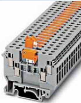
4 (6) mm²，16 A，刀闸分断端子，两进两出，带测试插孔螺钉
