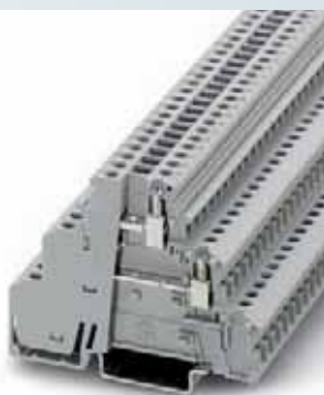
2.5 (4) mm², 30 A, 三层接线端子, 带两个直通层
