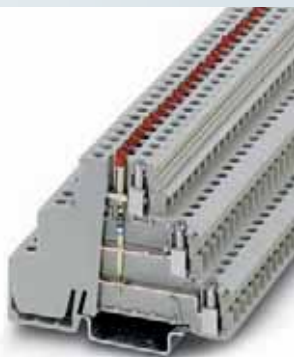
2.5 (4) mm 2 , 30 A, 三层接线端子, 带发光二极管
