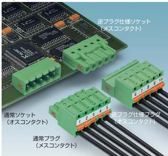
通常プラグ側がハンドセーフティ (感電防止) 構造になっているのに対し、逆プラグ仕様はソケット側がハンドセーフティ構造になっており、プリント基板から電線側に電流が流れるデザインに適しています。
