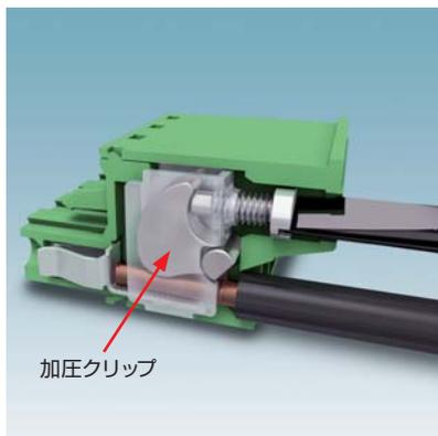
クランプねじを締めることにより加圧クリップが回転して電線を導通バーへ押し付け固定します。
