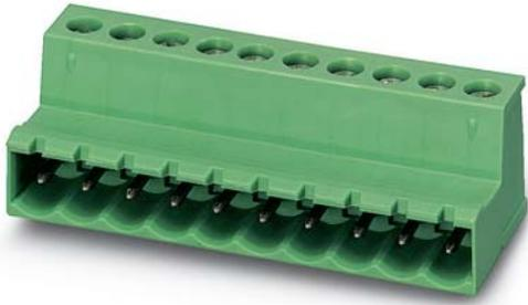
通常プラグ側がハンドセーフティ (感電防止) 構造になっているのに対し、逆プラグ仕様はソケット側がハンドセーフティ構造になっており、プリント基板から電線側に電流が流れるデザインに適しています。
