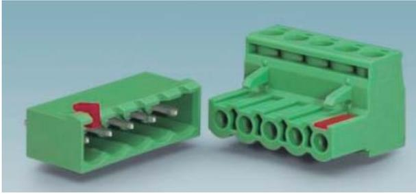
同一型式のソケットが混載されている場合、コーディングキーを使用することによって誤挿入を防止することができます。コーディングは、ソケット・プラグそれぞれにキーを持たせることで実現します。
