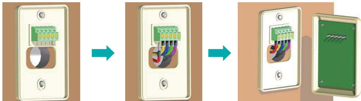
コネクタを取り付けるベースの形状を、製品に合わせて設計いただければ、製品について前後の爪でしっかりとコネクタを固定することができます。ベースの素材が弾性を期待できない場合でも、はめ込み後にスライドで固定するような設計をすることも可能です。取付けに必要な形状寸法はお問い合わせください。
