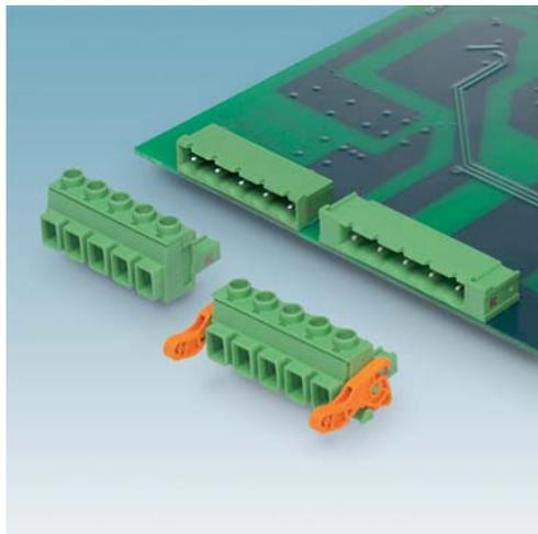
プラグ挿入の完了と同時に嵌合がロックされ、引抜きの際レバーを回転することで引抜きが補助されるロック&リリースレバー付き (右)
