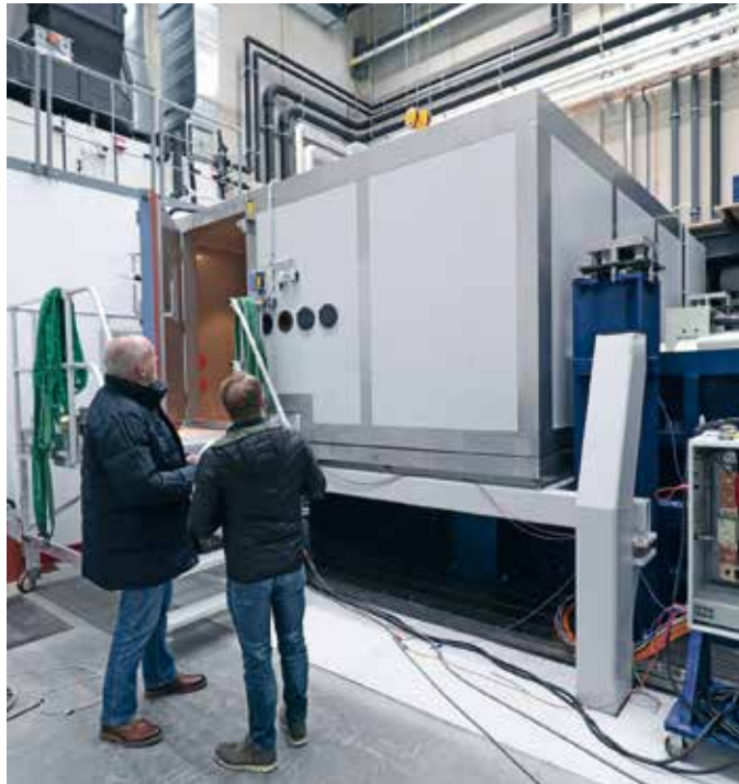
Ravistin pystyy ravistamaan testikappaleita, joiden paino on jopa neljä tonnia.
