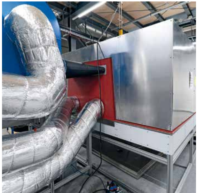
Lämpöshokkilaitteessa simuloidaan nopeita lämpötilanlaskuja - lämpötilan vaihdella jatkuvasti -40 °C...+75 °C välillä.
