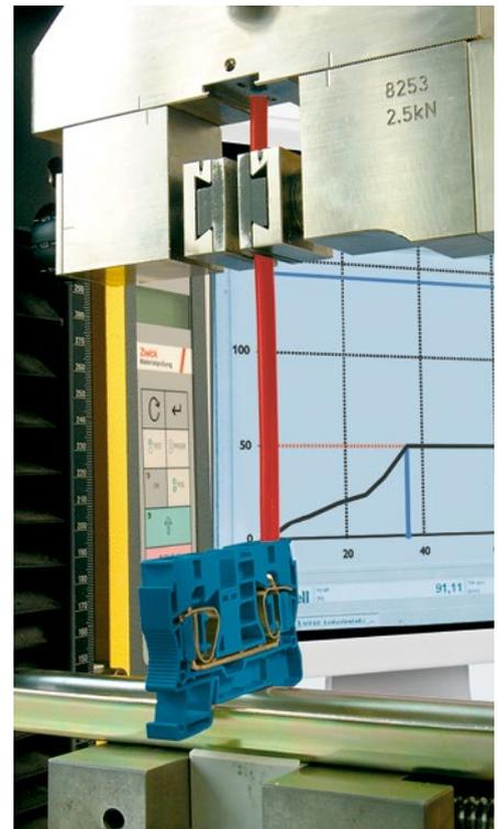
Absorción de la fuerza de tracción en una borna de conexión por resorte de 10 mm<sup>2</sup>
