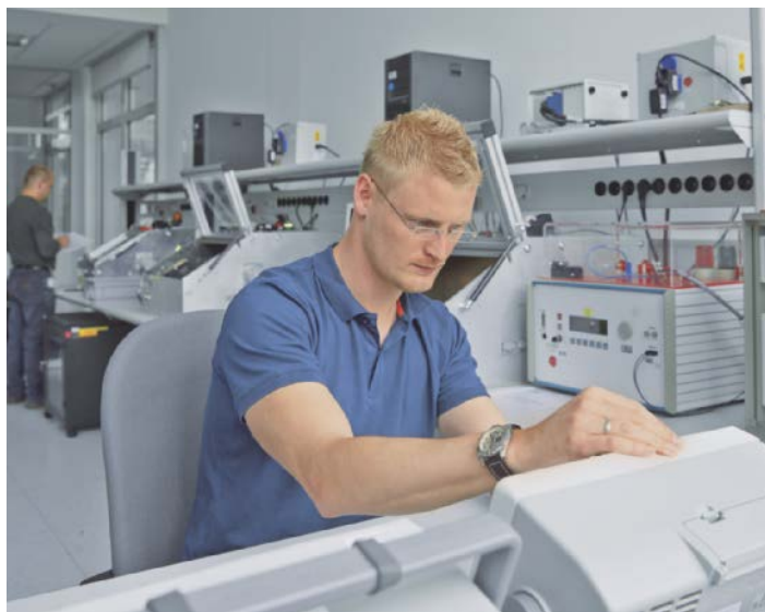
Fig. 26: Impianto di prova completamente automatico per la determinazione della reazione al sovraccarico e al guasto dei dispositivi di protezione contro le sovratensioni secondo IEC 61643-11 [6]
