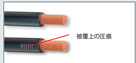
DIN IEC 60352に準拠して正しく剥ぎ取られたケーブル
