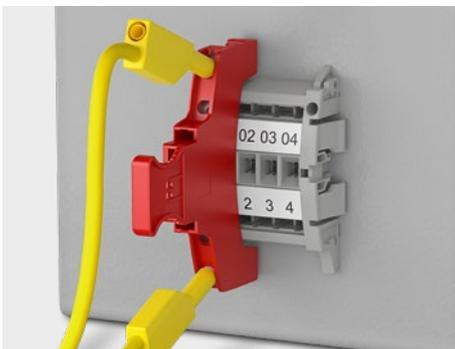
Für spezielle Prüfaufgaben erhalten Sie Servicestecker mit 4-mm-Prüfbuchsen in unterschiedlichen Polzahlen. Über die Prüfbuchsen lassen sich mit Sicherheitsprüfleitungen z. B. Messgeräte einschleifen.
