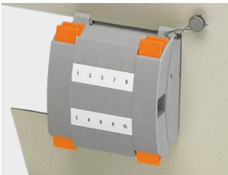
Durch die optionale Plombierung ist der Betriebsstecker vor unbefugtem Betätigen geschützt. Im Normalbetrieb deckt der Betriebsstecker die Kurzschlussbrücken und Stecköffnungen sicher ab.
