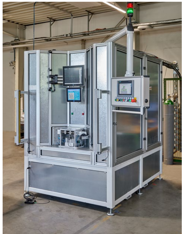
In der Fertigung werden z. B. Laserschweißautomaten verwendet
