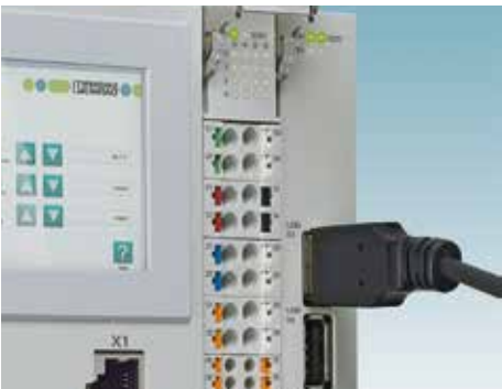
Зручні фронтальні роз'єми для передавання сигналів, даних і живлення
