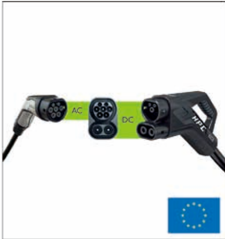
CCS type 2 2013年，欧盟委员会将符合IEC 62196-3标准的CCS type 2充电连接接口定义为欧盟统一的充电标准。与此同时，格陵兰岛、南美、南非、沙特阿拉伯和澳大利亚也确立了这一标准。交流和直流充电枪的接触面在交流侧是一样的，因此可连接同一个CCS车辆插座。
