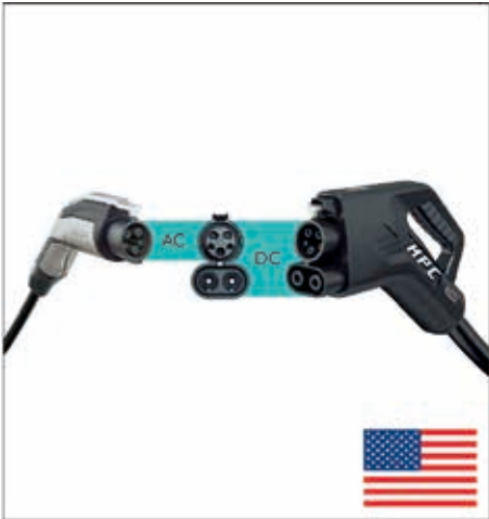
CCS type 1 符合SAE J1772和IEC 62196-3标准的CCS type 1组合式充电接口适用于北美，如今在韩国也越来越普遍。交流和直流充电枪的接触面在交流侧是一样的，因此可连接同一个CCS车辆插座。
